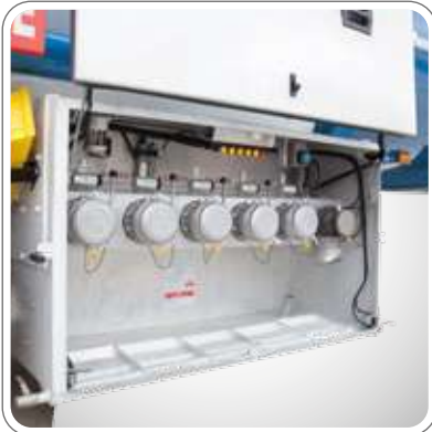
4" API ADAPTÖRLERLE POMPALI CEBRİ BOŞALTIM
