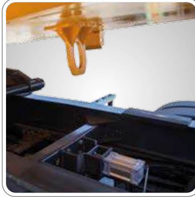
YENİ AITM YÖNETMELİĞİNE GÖRE HAREKET HALİNDE DAMPERİN KALKMASINI ENGELLEYEN KİLİT SİSTEMİ
