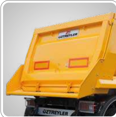
MANUEL VE HİDROLİK OPSİYONLU ÖZEL DİZAYN VE GÜÇLENDİRİLMİŞ ARKA KAPAK
